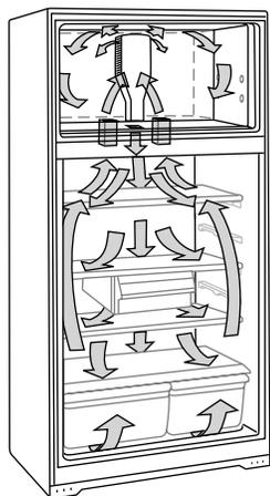
**Ne pas obstruer l'une ou l'autre de ces ouvertures d'aération** avec des aliments emballés. Si les ouvertures d'aération sont bloquées, le courant d'air sera empêché et des problèmes de température et d'humidité peuvent survenir.
