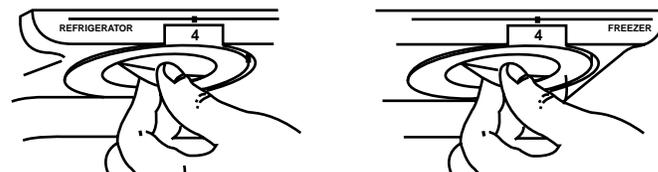
**REMARQUE :** Pour régler la commande du réfrigérateur à OFF (arrêt), tourner le réglage au mot OFF ou jusqu'à ce que le mot OFF (arrêt) apparaisse, comme indiqué ci-dessous. Votre appareil ne se refroidira pas lorsque la commande du réfrigérateur est réglée à OFF (arrêt).
