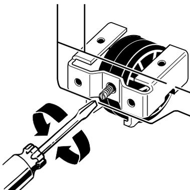
3. Selon votre modèle, pour mettre le réfrigérateur d'aplomb, vous pouvez tourner la vis dans le sens horaire pour soulever ce côté du réfrigérateur ou dans le sens antihoraire pour abaisser ce côté. Mettre un niveau sur le dessus du réfrigérateur pour vérifier les ajustements.
